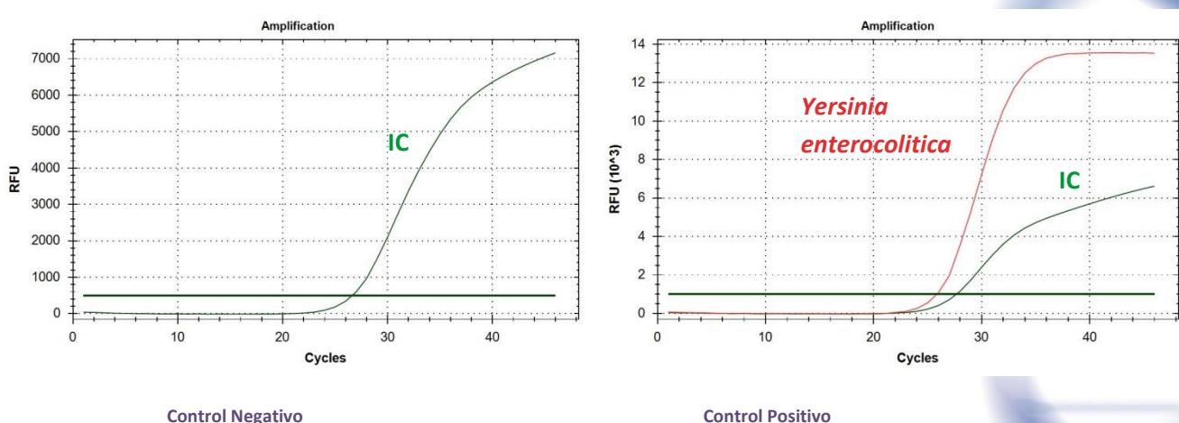
El resultado se considera inválido si se observa una gráfica de amplificación en el control negativo o ausencia de señal en el pocillo del control positivo. En ese caso, se recomienda repetir el ensayo.
